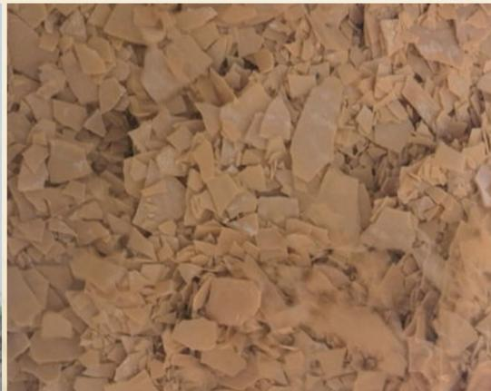
唐山三友采用 NaOH 洗涤 H<sub>2</sub>S 制得 NaHS，再将 NaHS 制成片剂供工业使用。图为 NaHS 制成片
